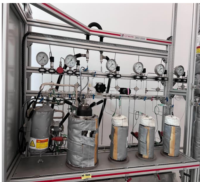
Conexiones y válvulas de CO2
